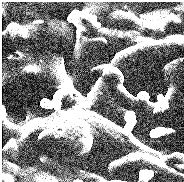
Abb.: 3.4.2 Mo-Fe-"Korallen" auf der Probe OF5 nach 5000 h bei 973 K, 5000 : 1
