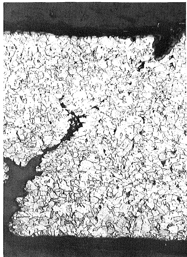
Abb. 24: Metallographische Schliffbilder vom Bruchgefüge des Stahles 1.4970 (Chg. 8-22075, LG + 14% KV + 800°C ) nach einer Zeitstandprüfung bei 700 bzw. 750°C
