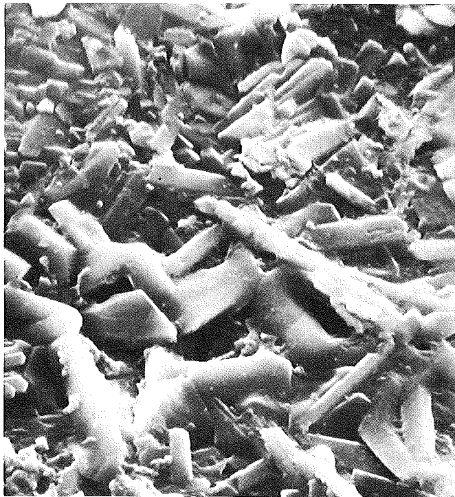
Abb. 6 REM-Strukturaufnahme der Oberfläche einer hochaktiven VCP 15 - Glaskeramik.
