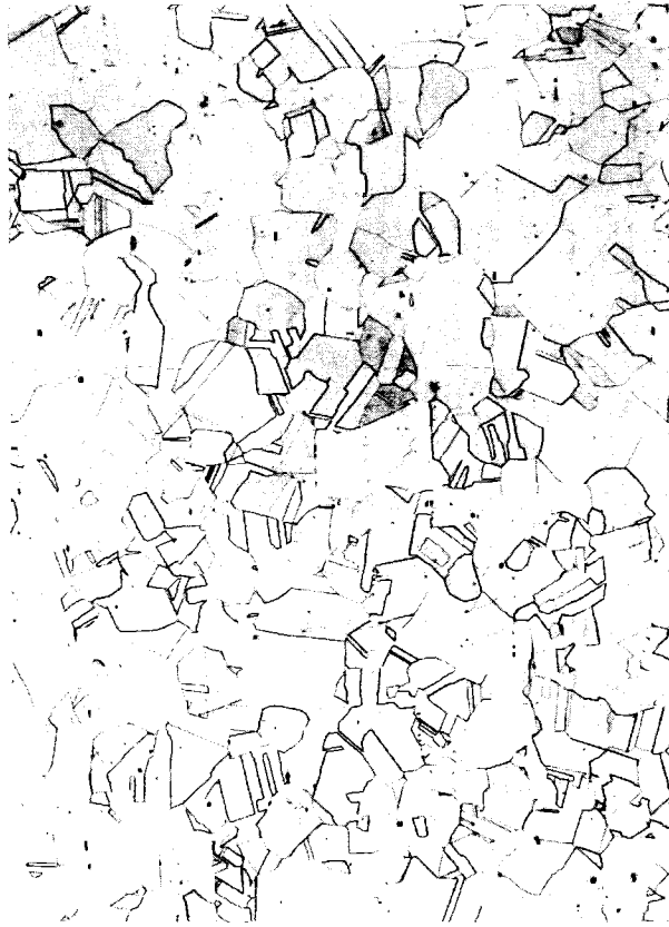
Abb. 21 Gefügebild des Werkstoffes 1.4948 (unbeanspruchtes Material, 50x)
