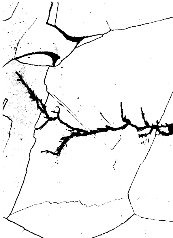
Abb. 24. Gefügaufnahme des Werkstoffes 1.4948 (Meßlänge: 50x, T = 550 °C, Haltezeit: Null)
