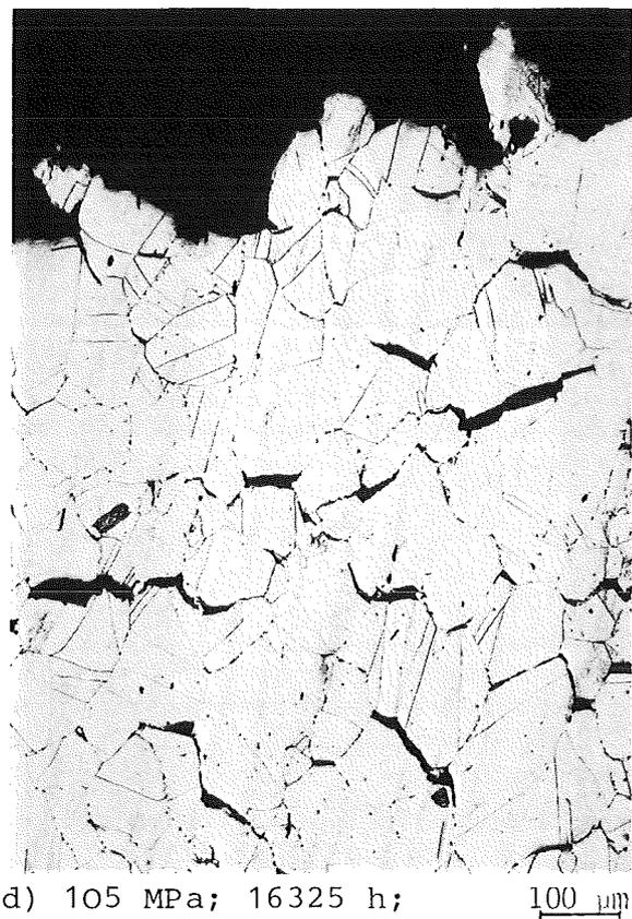
Bild 36: Geätzte Längsschliffe aus der Bruchzone einiger Zeitstandproben; XCrNi18 11; 1.4948; GW 206; Prüftemperatur 550°C (a) u. b)) und 600°C (c) u. d)).
