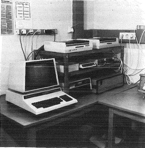
Rechner mit Dualfloppy, Protokollprinter, Etikettenprinter, Meßelektronik für die Dosisleistungssonden, Interfaces und Modem
