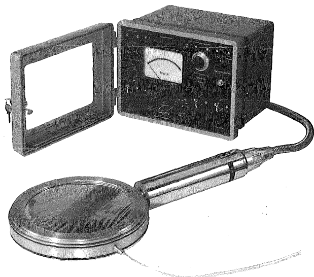
Abb. 23 Ein früher „tragbarer“ Kontaminationsmonitor mit Großflächen-Durchflußzählrohr (Werkfoto Berthold).
