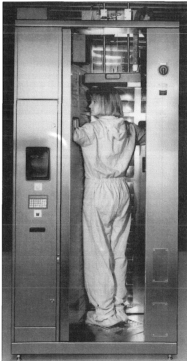
Abb. 31 Beispiel für die Anwendung von Großflächen-Proportionalzählrohren in einem Ganzkörper-Kontaminationsmonitor (Werksfoto Herfurth).
