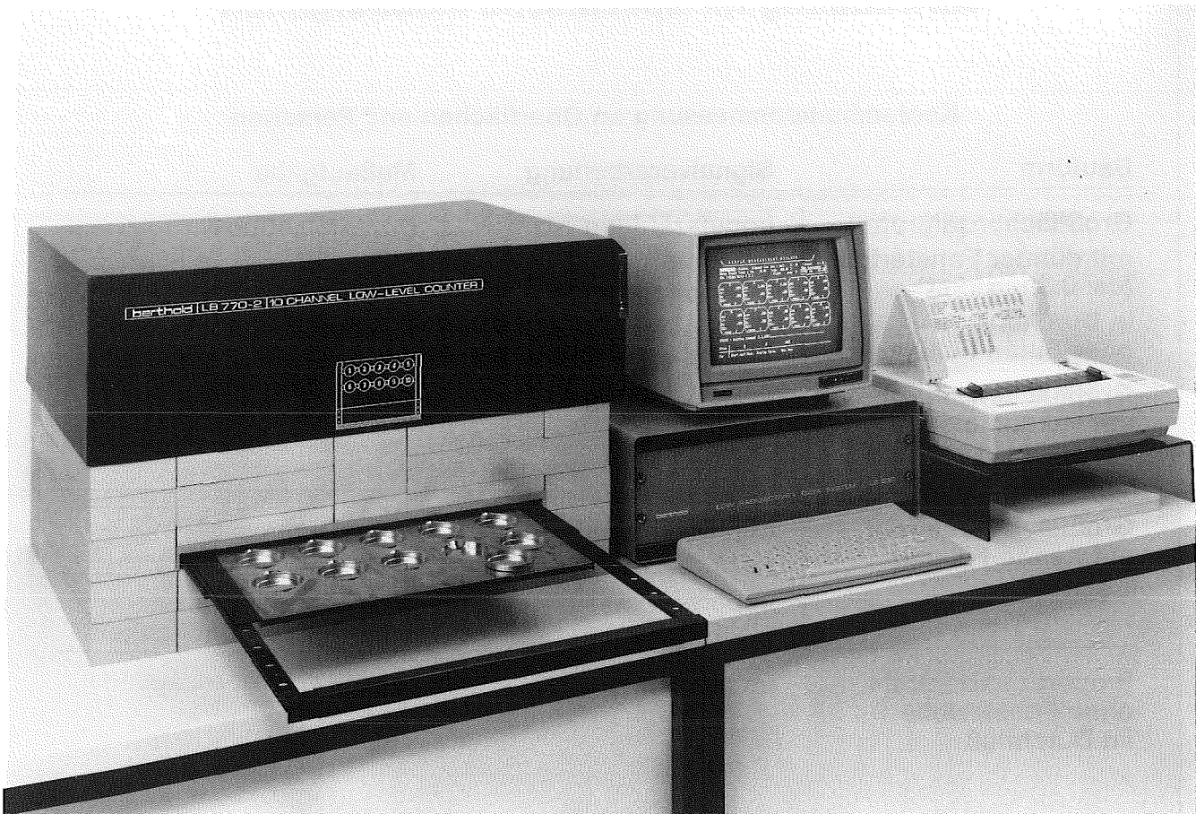
Abb. 22 Low-level-Meßplatz zur gleichzeitigen Messung von zehn 60-mm-Schälchen (Werksfoto Berthold).
