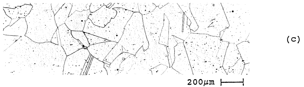
Abb.16 Gefügeänderung. Ni-VK, T_h=0.87 ; \dot{\epsilon}=2.8 \times 10^{-4}/\text{s}
