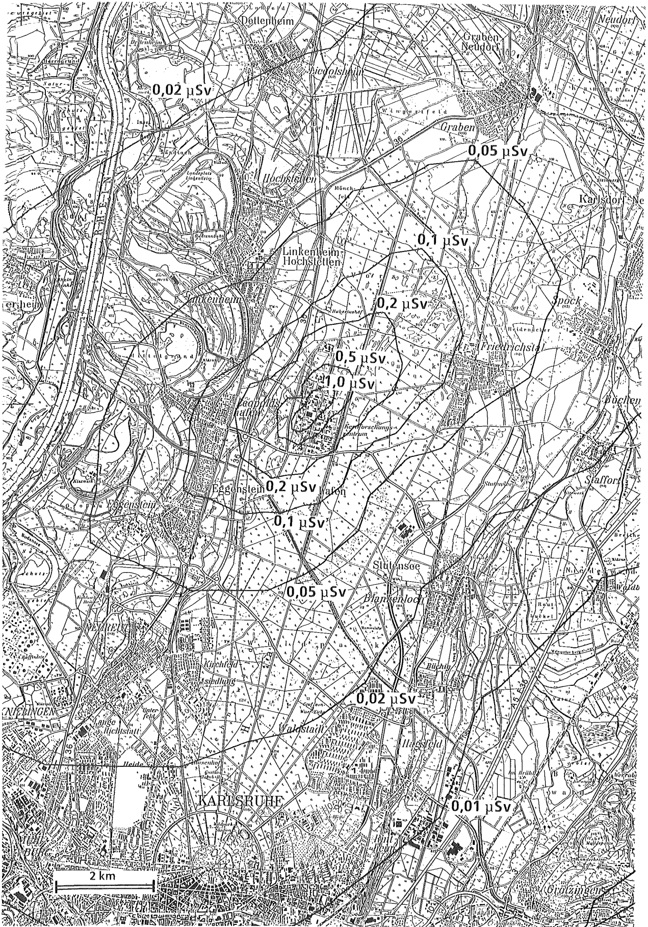
Abb. 5/3: Effektivdosen in der Umgebung des KfK, 50-Jahre-Folgedosis aufgrund der Emissionen 1992
