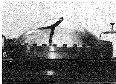
Abb. 6: Verformte Membran nach dem Versagen.
