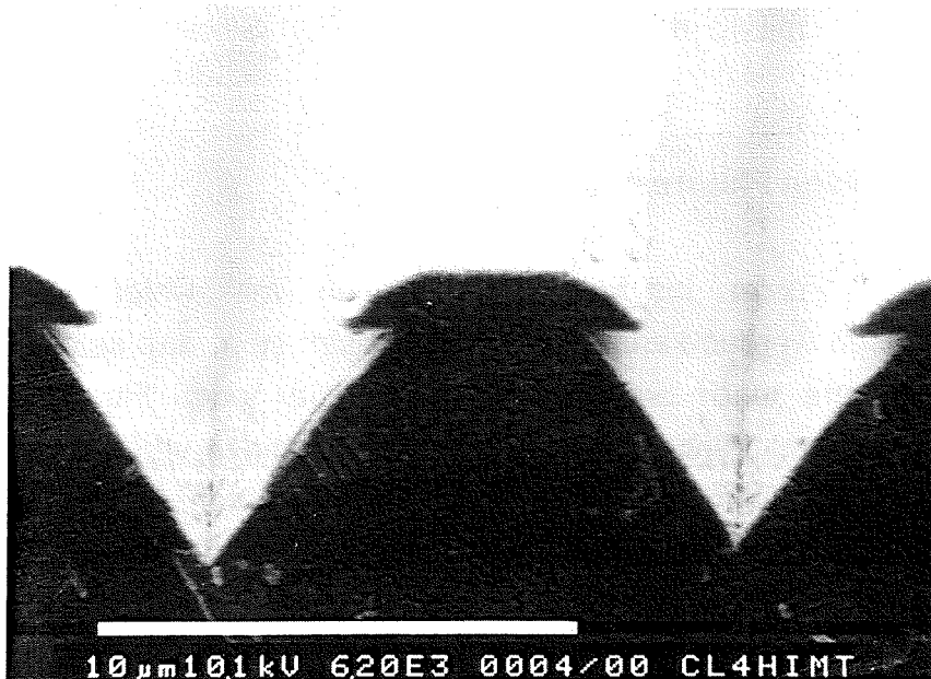
Abb. 4.3 REM-Aufnahme einer durch laserinduziertes Ätzen mit 100 mbar Chlor erzeugten Siliziumstruktur. Der Böschungswinkel in den Gräben entspricht mit 55^\circ der Neigung der 111-Ebene im Siliziumkristall
