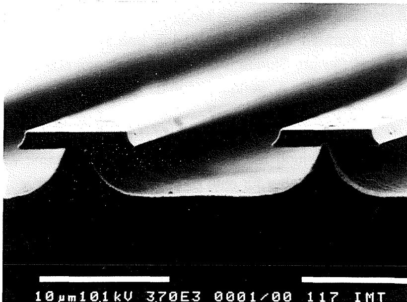
Abb. 3.5 REM-Aufnahme einer mit 20 mbar Fluor und Laserunterstützung bei 308 nm geätzten Siliciumstruktur. Die Ätztiefe beträgt nach 1 Stunde etwa 5 μm. Die SiO 2 -Maske ist praktisch nicht angegriffen worden.
