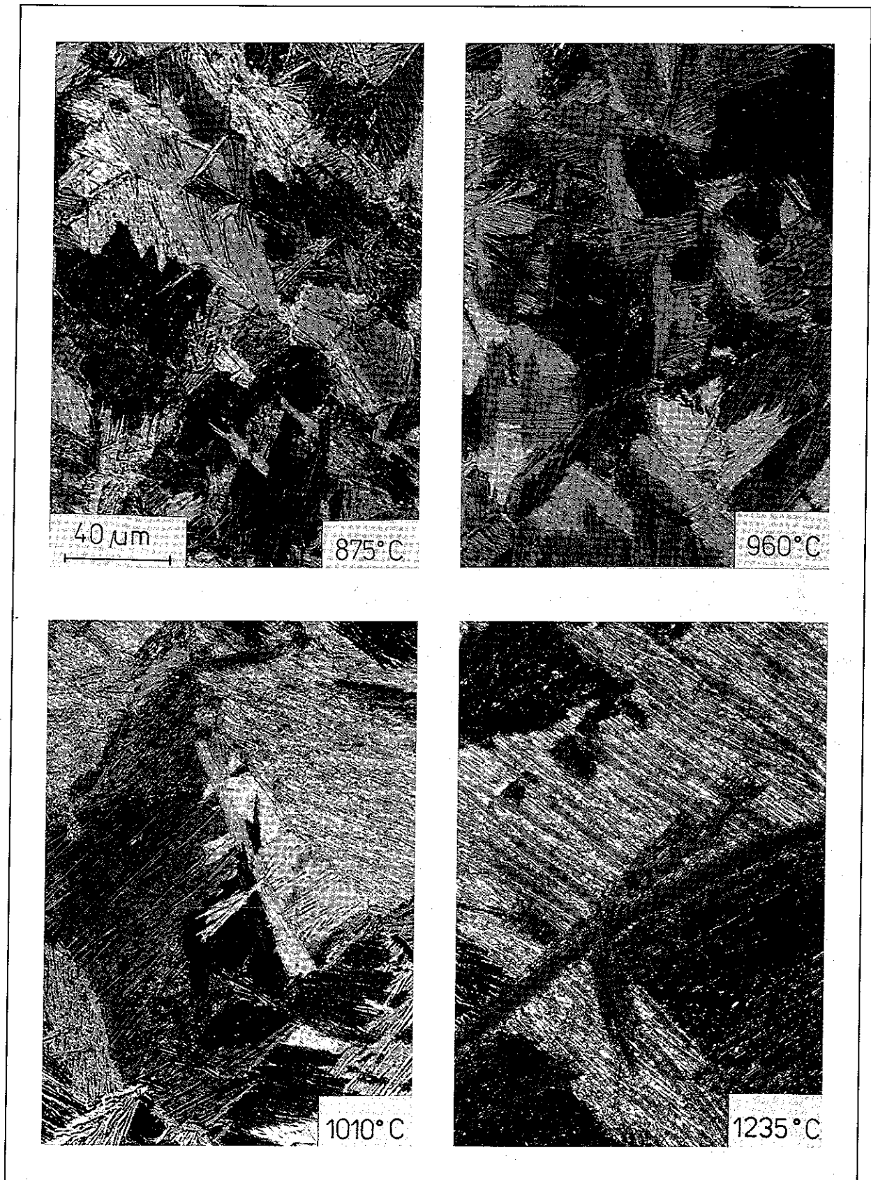
Abb. 32: Gefüge im Berstquerschnitt in Abhängigkeit von der Bersttemperatur nach vollständiger \alpha - \beta -Umwandlung (ZrNb1, Aufheizrate 1 K/s, wischpoliert, polarisiertes Licht).
