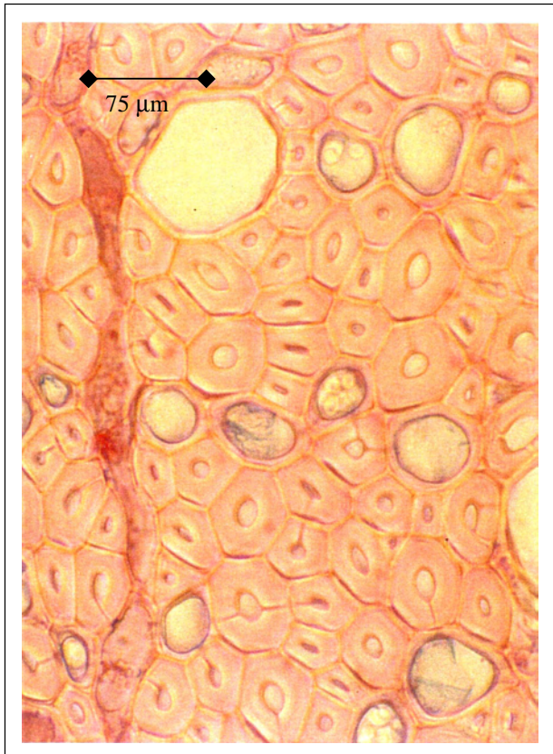
Abbildung 4.42: Querschnitt durch Stützholz; Die Zellwände sind vollständig verholzt (rot angefärbt), Ebene 1, Druckseite.
