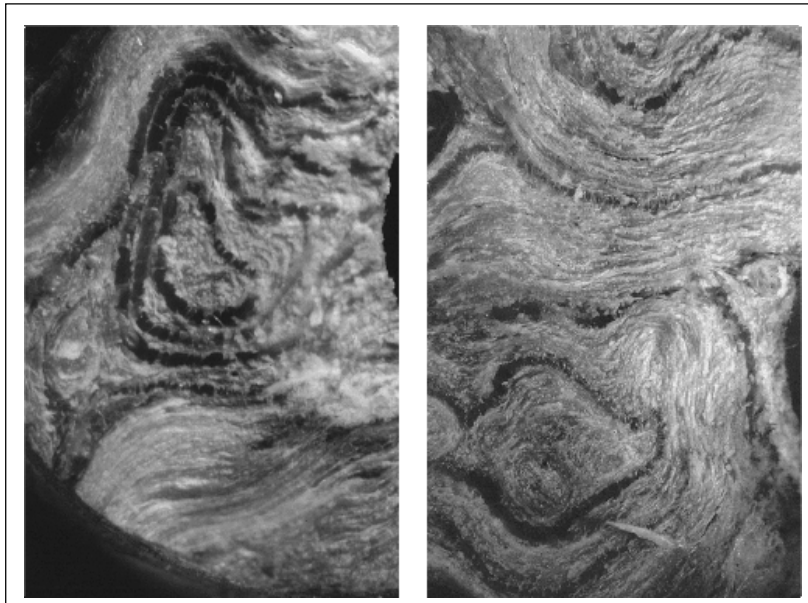
Abbildung 4.26: Bruchflächen des aus der Achsel eines Eichenastes ( Quercus robur L.) entnommenen Bohrkerns (16-fach vergrößert). Bemerkenswert ist der unregelmäßige Verlauf der Fasern und Gefäße.
