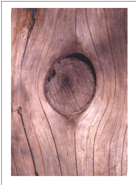
Abbildung 3.7: Spindelförmiger Faserverlauf um einen morschen Ast.
