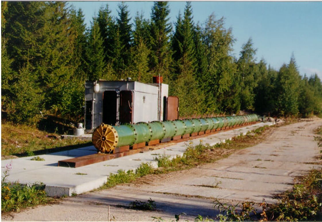
Abb.7.1.6: TORPEDO- Rohr des Kurchatov Instituts Moskau für H_2 -Luft Verbrennungsversuche, Durchmesser 0.52, Länge 30 m.
