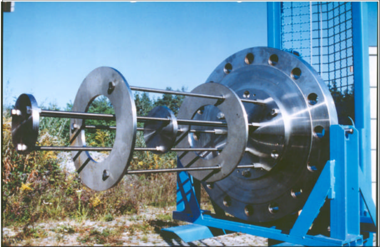
Abb.8.5.4.6: Plattentarget für Detonationsversuche im FZK- 12m-Rohr. Bei diesem Target treten kombinierte Wellenreflexionen und- beugungen auf.
