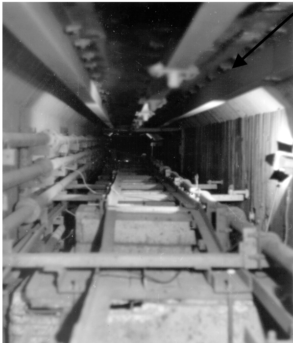
Abb.8.4.6.1: Prinzipskizze der RUT- Anlage für Großexperimente mit Wasserstoff- Luft- Dampfgemischen und Ausrichten des linken Kanals mit Betonhindernissen und Rohrleitungen zum Heizen der Anlage auf ca. 100°C.
