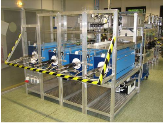
Neu aufgebauter Teststand für Korrosionstests in Blei-Wismuth.
