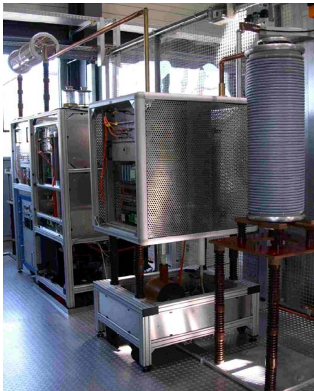
Hochspannungskontrollsystem für die Gyrotrons. Links: Modulator, Crowbar und Zündspule. Rechts: Thyatron mit neu entwickelter externer Anordnung zum Schutz der Gyrotrons.
