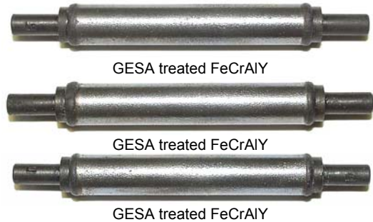
GESA modifizierte FeCrAlY beschichtete 1.4970 Hüllrohre nach 10000h bei 550 °C in Blei-Wismuth.
