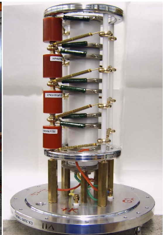
Hochspannungskontrollsystem für die Gyrotrons. Links: Modulator, Crowbar und Zündspule. Rechts: Thyatron mit neu entwickelter externer Anordnung zum Schutz der Gyrotrons.
