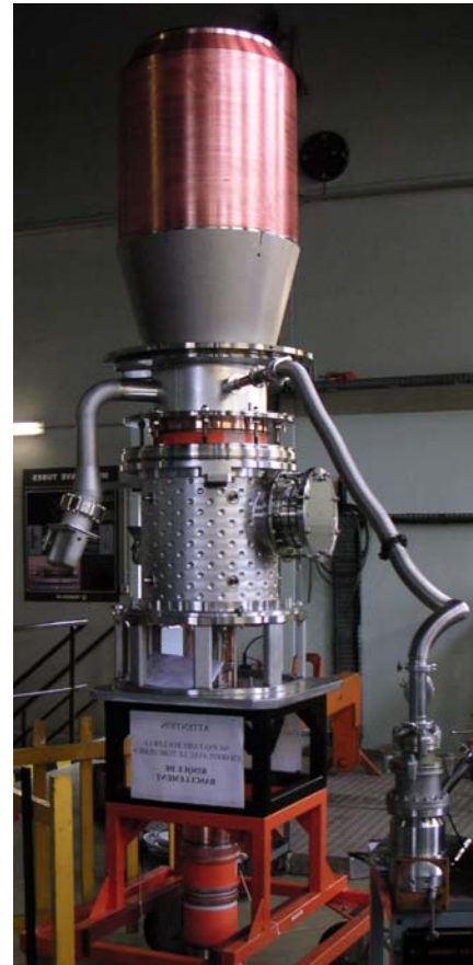
Prototyp des koaxialen 2 MW, 170 GHz Gyrotrons.
