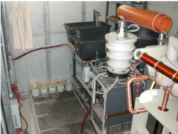
Aufbau des Kreislaufs an der Franka-0 für die kontaminationsarme Fragmentierung von hochreinem Quarz.
