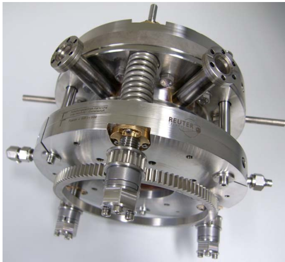
Doppelscheibenfenster mit feineinstellbarem Scheibenabstand für ASDEX-Upgrade.
