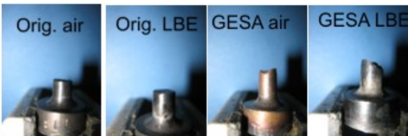
Morphologie der Bruchflächen nach dem Test, links T91 original, rechts T91 mit GESA modifizierter Schicht.
