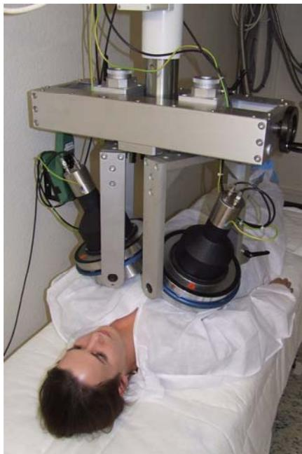
Abb. 5-15: Teilkörperzähler mit Phoswich-Detektoren der Hauptabteilung Sicherheit
