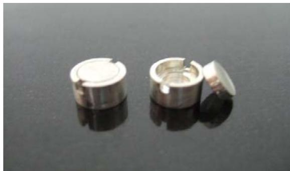
Abb. 5-10: Verwendete Zinnkapseln als Energiekompensationsfilter
