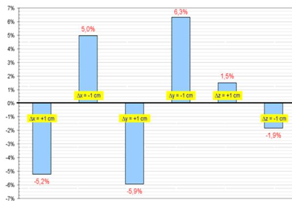
Abb. 5-22: Sechs ausgewählte Werte von Wirkungsgradabweichungen bei x- (links nach rechts), y- (Rücken zum Bauch) und z- (Kopf zu Füßen) Bewegungen des Detektors relativ zur Referenzposition
