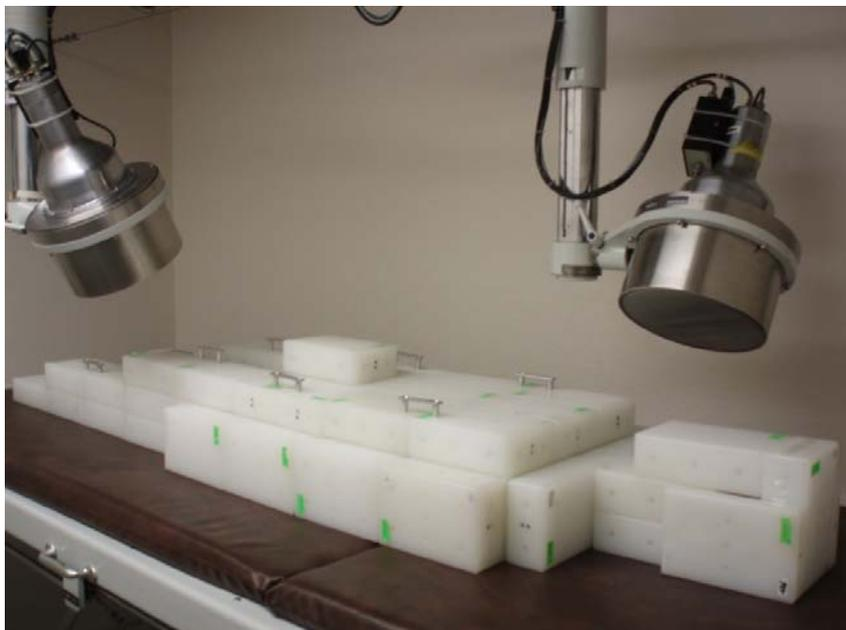
Abb. 4-4: Das in den Ringvergleichen und zur Kalibrierung verwendete Ziegelphantom „Igor“
