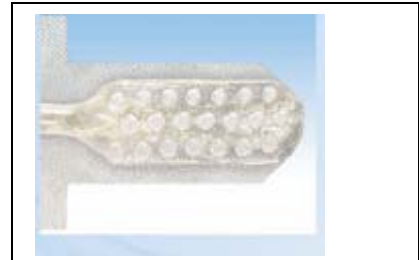
Fig. 27 Elektrodenarray bestehend aus 21 flachen Elektroden die auf die Oberfläche des Stammhirns aufgebracht werden. Quelle: Cochlear Ltd ( http://www.cochlear.com/ )
