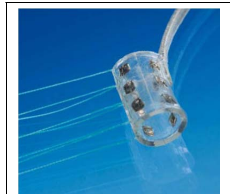
Fig. 18 Cuff-Elektrode des Fallfußstimulators „ActiGait“ der Firma „Neurodan“ (Quelle: Patienteninformationsbrochure ( http://www.ottobock.de ))
