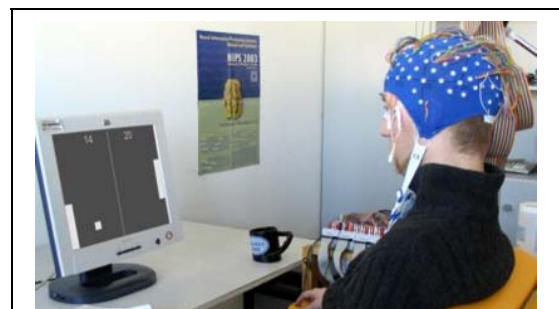
Fig. 7 Steuerung eines Cursors mittels EEG (Quelle: http://ida.first.fraunhofer.de/bbci/ )
