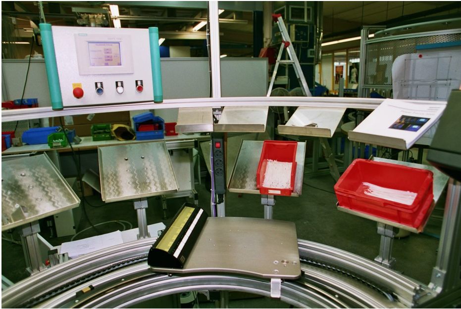
Abb. 4: Weiterentwicklung des halbkreisförmigen Montagearbeitsplatzes (Lotter LP Montagetechnik)
