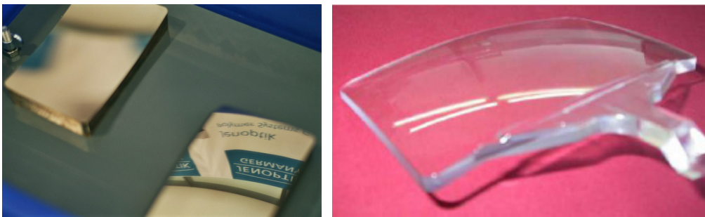
Abb. 2, links: Gefräste, spiegelnde Formen für Freiformspiegel. Größe: 128x77 mm.
