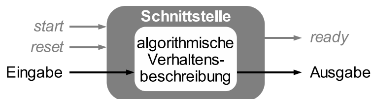
Abbildung 3.18: Vollständige Schaltungsbeschreibung auf der algorithmischen Ebene
