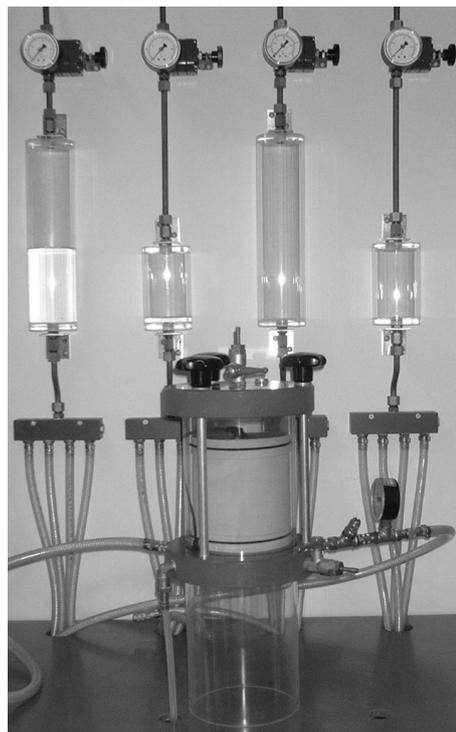
Abbildung 4.10: Zylinderförmige Stubensandsteinprobe ( $\varnothing = 10$  cm) in der Druckzelle.
