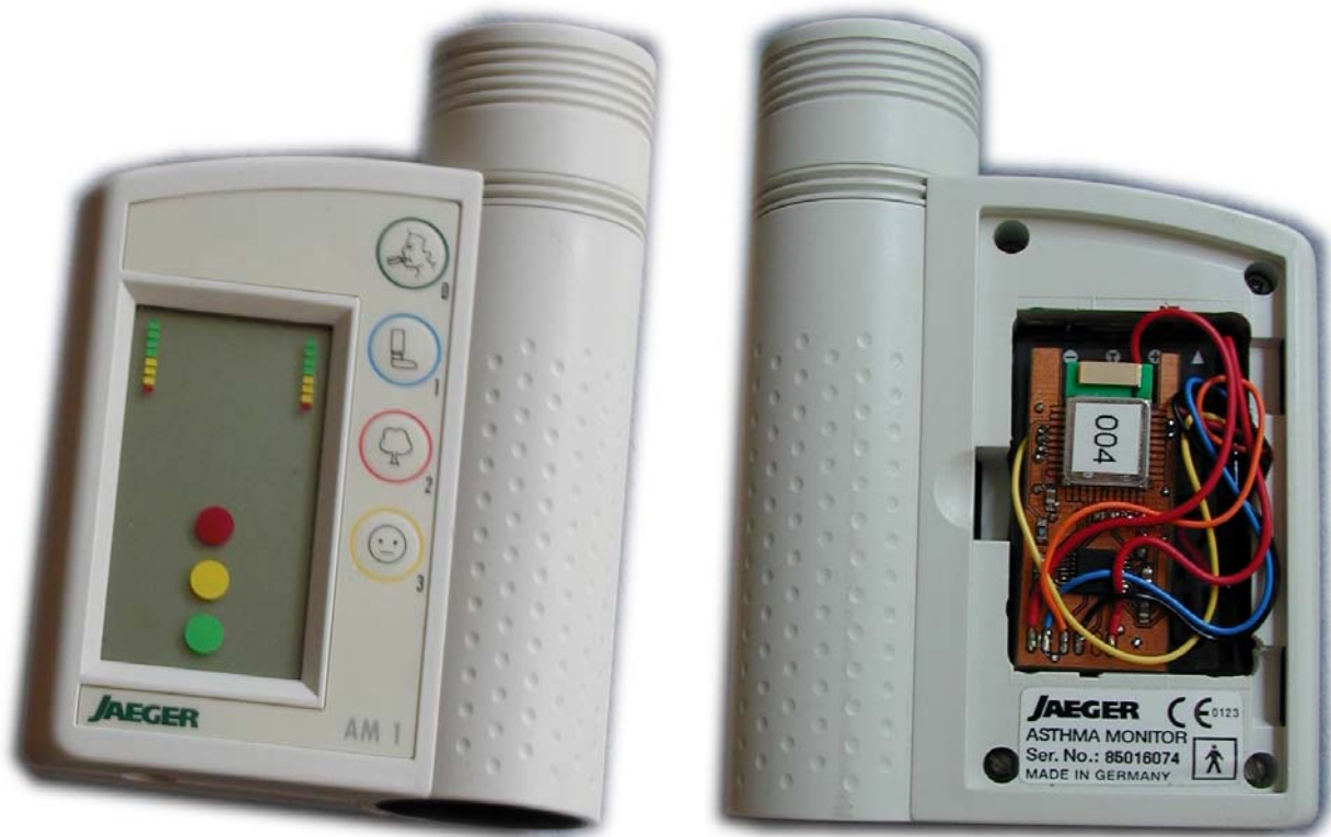
Abbildung 7-15: Integration der Sensornetzwerk-Elektronik in den Asthmamonitor AM1
