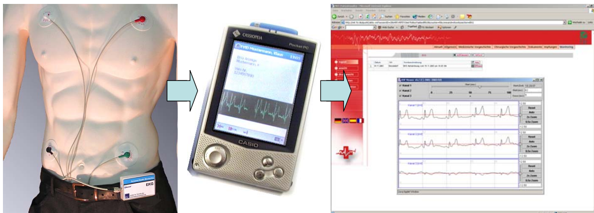
Abbildung 7-14: Anbindung des EKG-Demonstrators an eine Web-basierte Patientenakte
