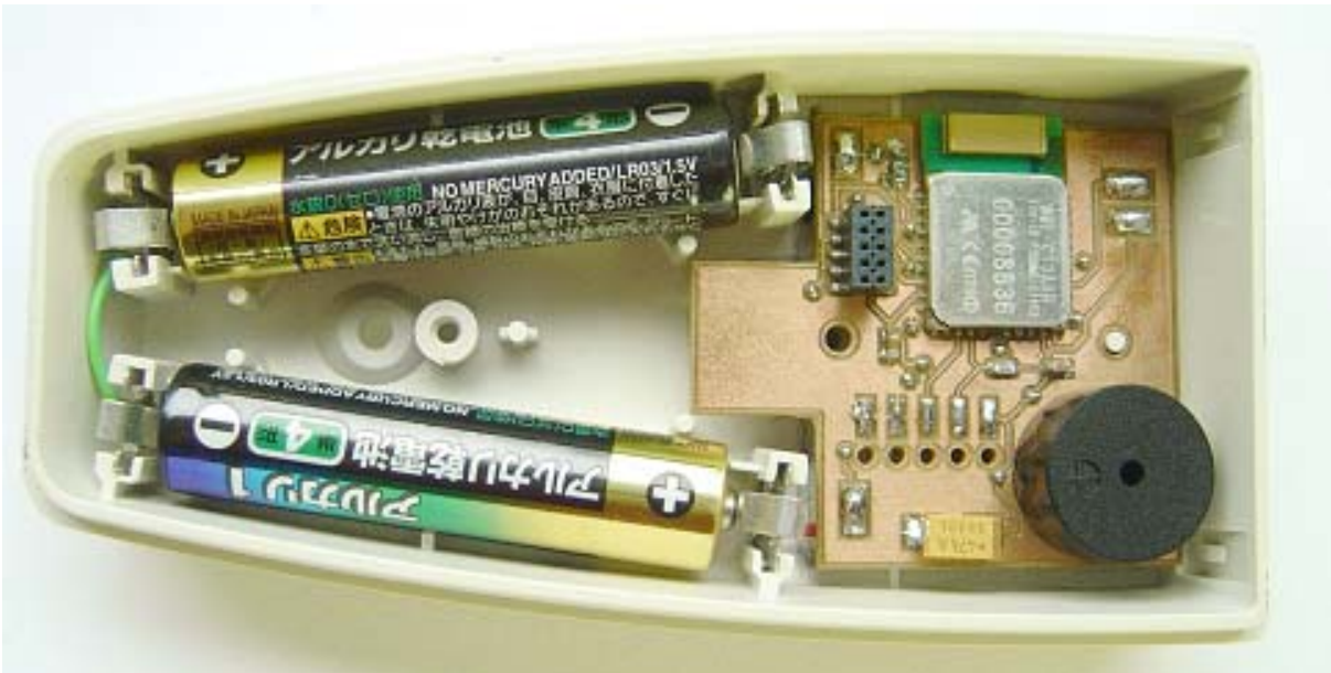
Abbildung 7-19: Sensornetzwerkelektronik im externen Handgehäuse als Zubehör für ein Blutdruck-Messgerät
