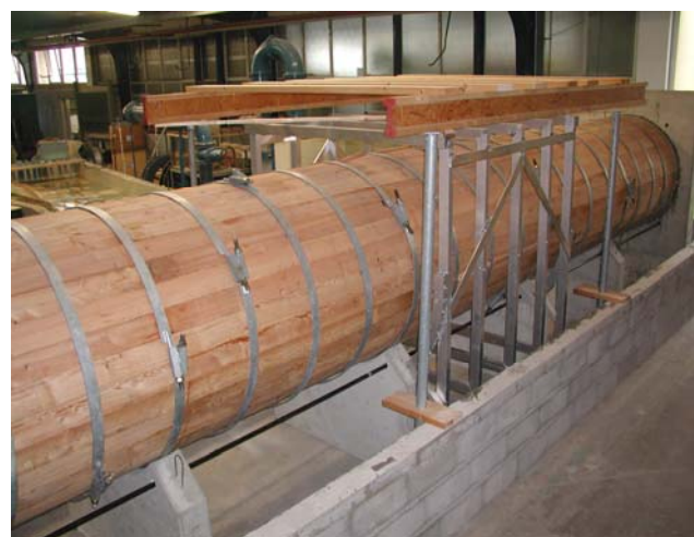
Abb. 5 Versuchsstand zur Untersuchung des Biegetragverhaltens von Druckrohrleitungen aus Holz
