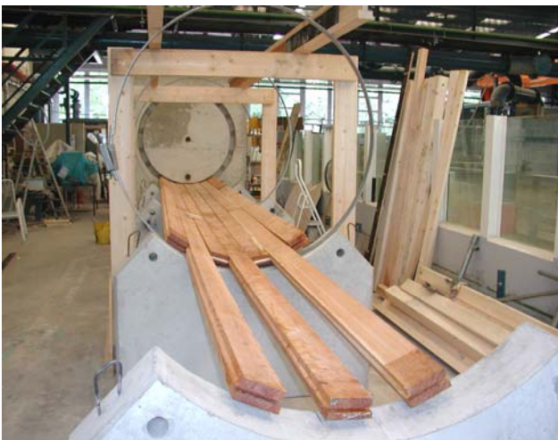
Abb. 5 Versuchsstand zur Untersuchung des Biegetragverhaltens von Druckrohrleitungen aus Holz
