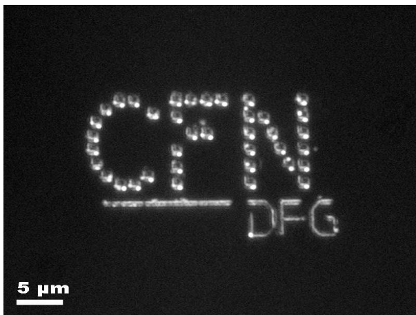
Abbildung 3.6: Lichtmikroskopische Aufnahme einer strukturierten Goldschicht (500-fache Vergrößerung, Dunkelfeldbeleuchtung). Das Logo des „DFG-Center for Functional Nanostructures CFN“ wurde direkt mit dem Strukturierungs-AFM in eine Goldschicht auf einem Siliziumsubstrat geschrieben.
