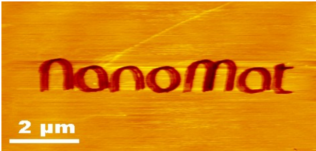
Abbildung 4.7: Struktur in einer Glimmeroberfläche (Logo des Netzwerks für Nanomaterialien „nanomat“), aufgenommen im Kontaktmodus, Strukturgröße 7 \times 1 \mu\text{m}^2 . Die Linien sind bis zu 4 nm tief. An der dünnsten Stelle beträgt die Linienbreite 90 nm, ist aber in X-Richtung durch thermische Drift auf 300 nm verbreitert.
