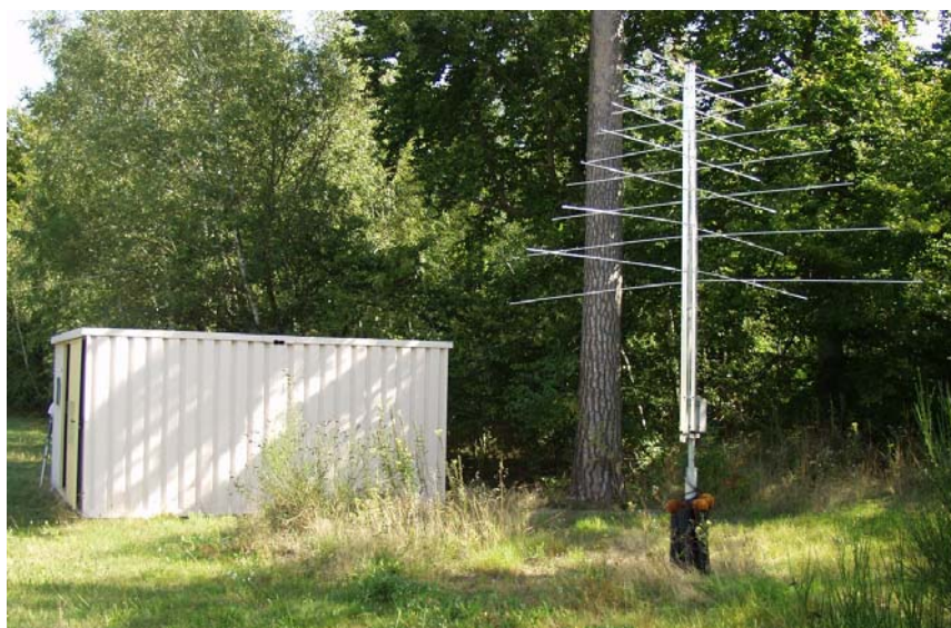
Abbildung 5.3: Container der Teilchendetektor-Station Nr. 17 des Luftschauerexperimentes KASCADE-Grande mit einer logarithmisch-periodischen Dipolantenne der Empfängerstation LOPES STAR I.
