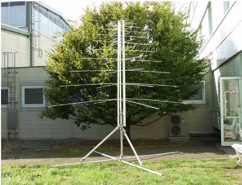
Abbildung 3.11: Photographie der kreuzpolarisierten logarithmisch-periodischen Dipolantenne.
