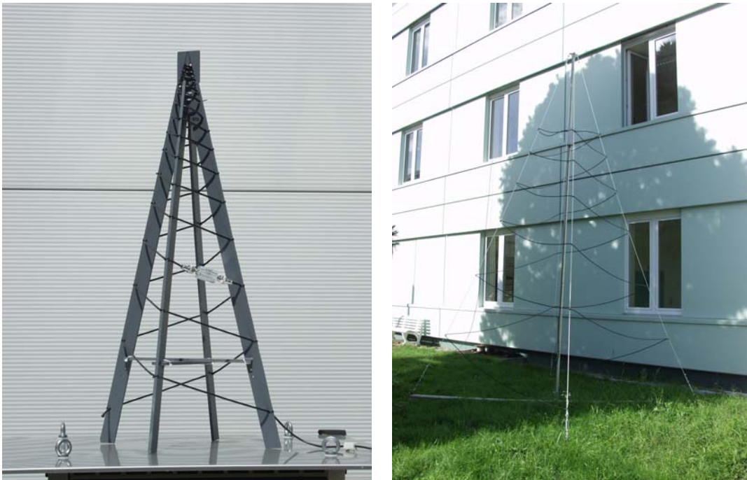
Abbildung 3.6: Logarithmisch-periodische konische Spiralantenne mit 1 m Höhe für den Frequenzbereich von 200 MHz bis 1000 MHz (links). Mit diesem verkleinerten Modell wurden insbesondere Untersuchungen der Richtcharakteristik durchgeführt. Die Spiralantenne für den geforderten Frequenzbereich von 40 MHz bis 80 MHz besitzt eine Höhe von 5 m und eine Basisfläche von 4 \times 4 \text{ m}^2 (rechts). Beide Antennen besitzen zwei symmetrische Spiralarme. Der symmetrische Speisepunkt befindet am spitzen Ende.
