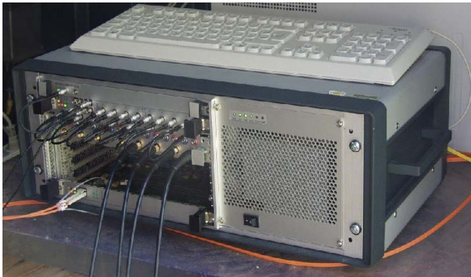
Abbildung 4.18: VME-Rack einer 8-kanaligen Empfängerstation bestückt mit Empfänger- und Datenerfassungskomponenten. Von oben nach unten: 80 MHz-Abtasttaktgenerator (Eigenentwicklung), ADC-Modul (SIS 3300, SIS GmbH), Patch-Panel (Eigenentwicklung), Filter-Demodulator-Modul (Eigenentwicklung, Abbildung 4.8), VME/PCI-Interface (SIS 1100/3100, SIS GmbH). Bei voller Aufrüstung wird ein weiterer Steckplatz von der Selbsttriggerelektronik (Eigenentwicklung, Kapitel 6) belegt. Ein Glasfaserkabel (orange) dient der Verbindung mit dem LINUX-PC im Hintergrund.
