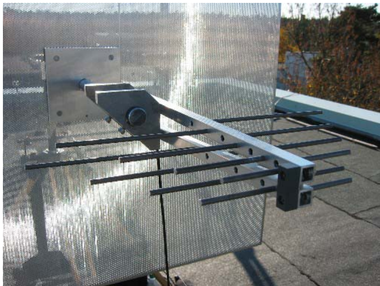
Abbildung 3.22: Um den Faktor 10 verkleinerte log.-per. Dipolantenne vor einer 1 x 1 m 2 großen Metallplatte (Bodensubstitution). Der Abstand zwischen Antenne und Metallplatte ist variabel. Die gesamte Anordnung ist drehbar.
