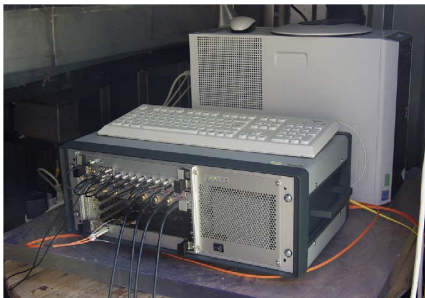
Abbildung 5.4: Empfängerelektronik mit Datenerfassungssystem im Inneren eines KASCADE-Grande Containers.
