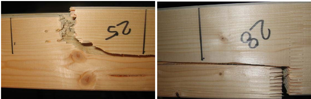
Bild A-9 Träger 2: Kombiniertes Holz- und Keilzinkenversagen
