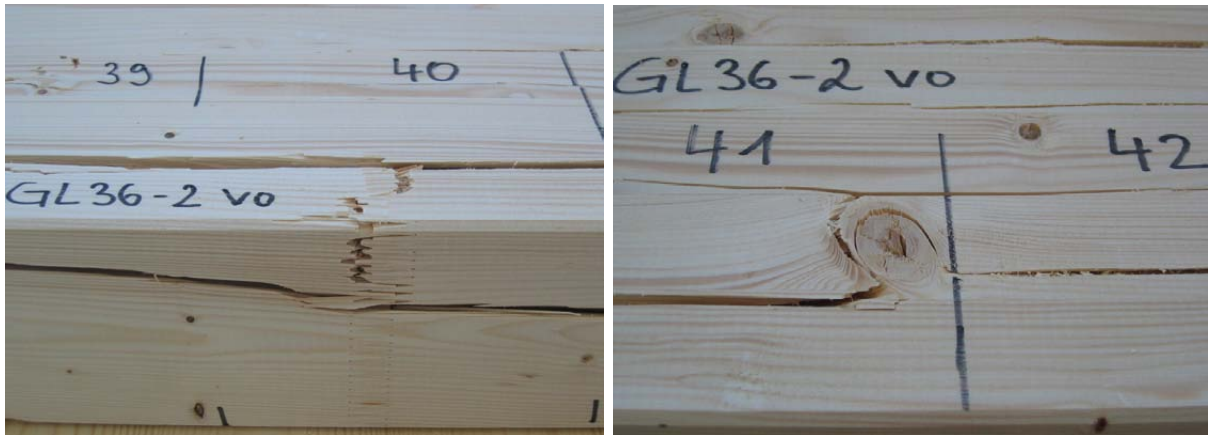
Bild A-96 GL36c-2: Keilzinkenversagen in der Randlamelle, Untersicht (links) und Holzversagen in der 2. Lage, Ansicht (rechts)
