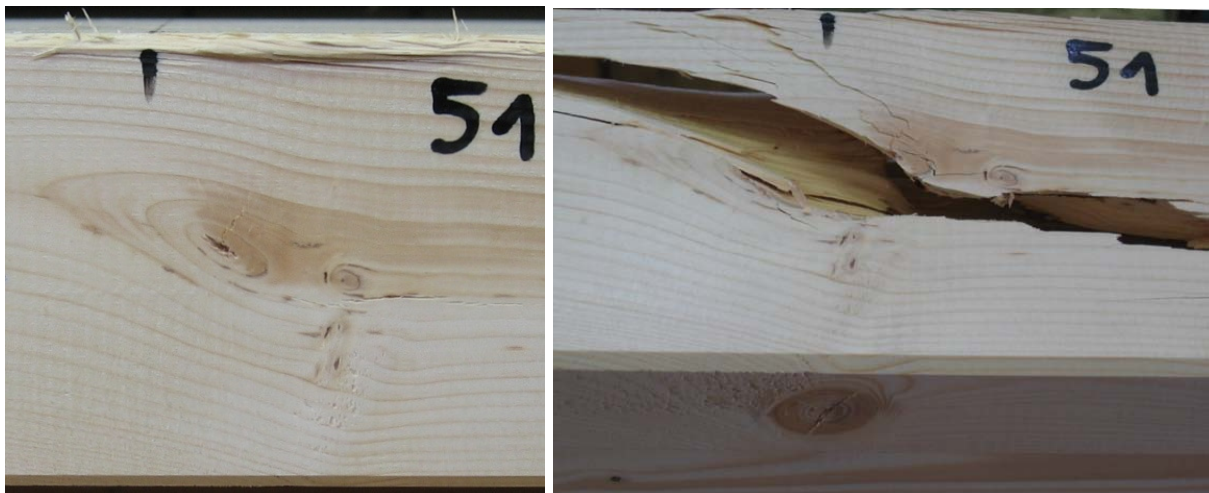
Bild A-93 GL32c-18: Holzversagen in der Randlamelle, Untersicht vor dem Versagen (links) und danach (rechts)
