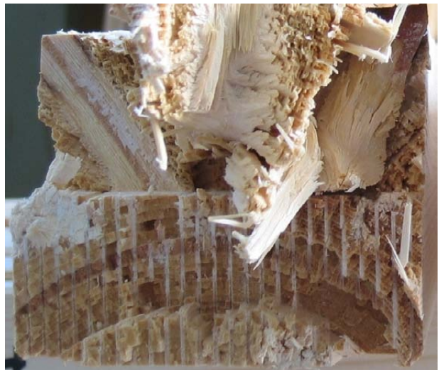
Bild A-88 GL32c-13: Keilzinkenversagen in der Randlamelle, Untersicht (links) und Detail (rechts)
