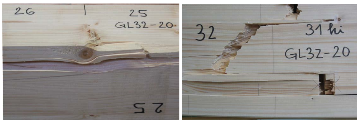
Bild A-95 GL32c-20: Holzversagen in der Randlamelle, Untersicht (links) und Keilzinkenversagen, Ansicht (rechts)
