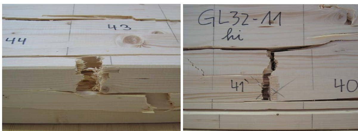
Bild A-86 GL32c-11: Holzversagen in der Randlamelle, Untersicht (links) und Keilzinkenversagen in der 2. Lage, Ansicht von hinten (rechts)
