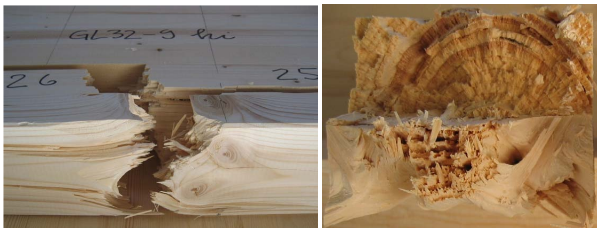
Bild A-84 GL32c-9: Holzversagen in der Randlamelle, Untersicht (links) und Detail (rechts)
