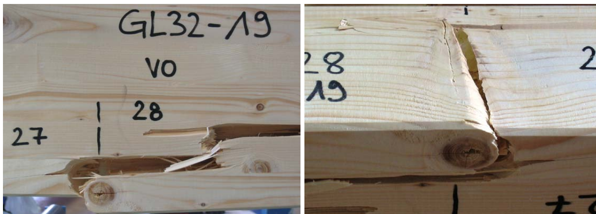
Bild A-94 GL32c-19: Holzversagen in der Randlamelle, Ansicht (links) und Untersicht (rechts)
