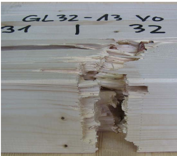
Bild A-88 GL32c-13: Keilzinkenversagen in der Randlamelle, Untersicht (links) und Detail (rechts)
