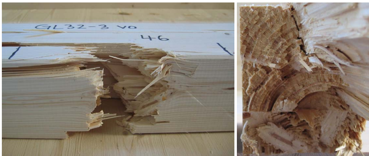
Bild A-78 GL32c-3: Holzversagen in der Randlamelle, Untersicht (links) und Detail der Bruchstelle (rechts)
