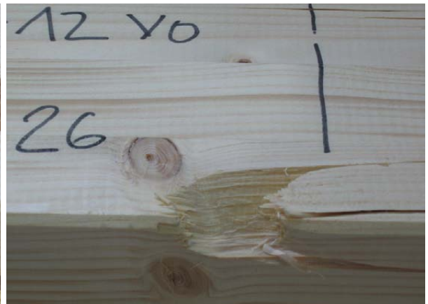
Bild A-87 GL32c-12: Holz- und Keilzinkenversagen in der Randlamelle, Untersicht (oben) und Details (unten)
