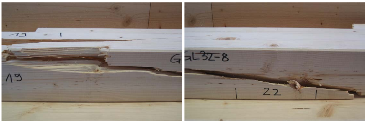
Bild A-83 GL32c-8: Holzversagen an zwei Stellen in der Randlamelle, 2 x Untersicht
