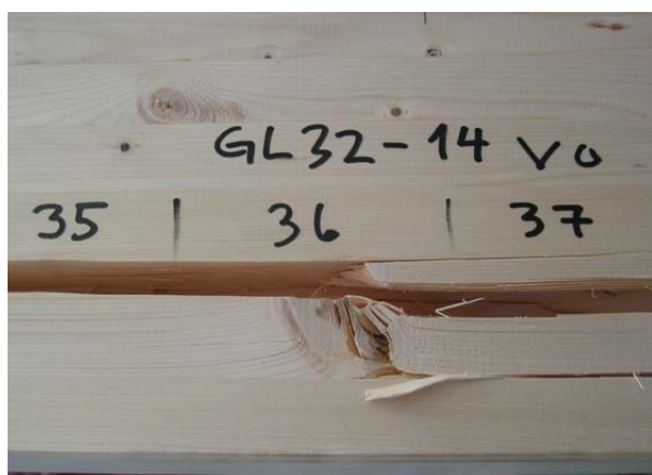
Bild A-89 GL32c-14: Holzversagen in der Randlamelle, Ansicht (oben) und in der 2. Lage, Ansicht von vorne und von hinten (unten)
