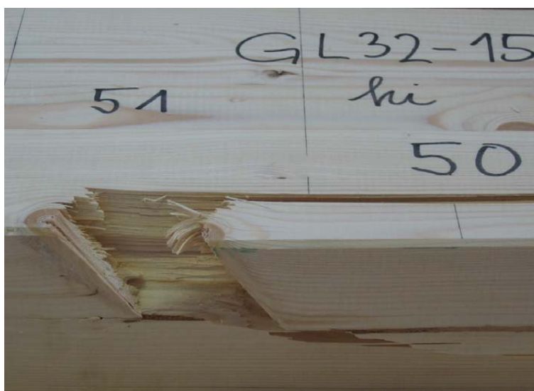
Bild A-90 GL32c-15: Holzversagen in der Randlamelle
