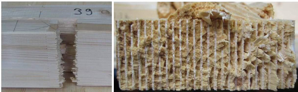
Bild A-77 GL32c-2: Keilzinkenversagen in der Randlamelle, Untersicht (links) und Detail (rechts)
