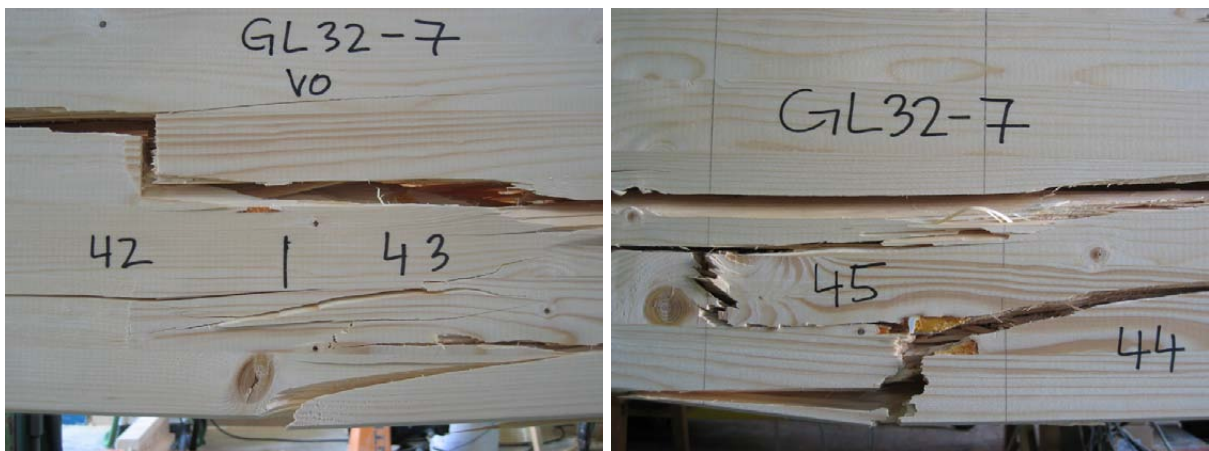
Bild A-82 GL32c-7: Holzversagen an zwei Stellen in der Randlamelle, Ansicht von vorne (links) und von hinten (rechts)
