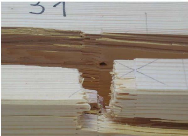
Bild A-87 GL32c-12: Holz- und Keilzinkenversagen in der Randlamelle, Untersicht (oben) und Details (unten)
