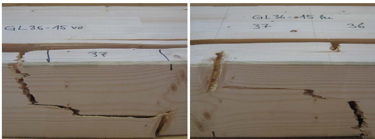
Bild A-98 GL36c-15: Holzversagen in der Randlamelle, 2 x Untersicht
