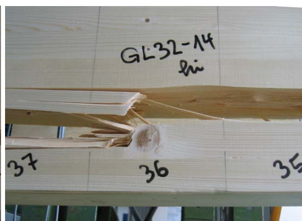
Bild A-89 GL32c-14: Holzversagen in der Randlamelle, Ansicht (oben) und in der 2. Lage, Ansicht von vorne und von hinten (unten)
