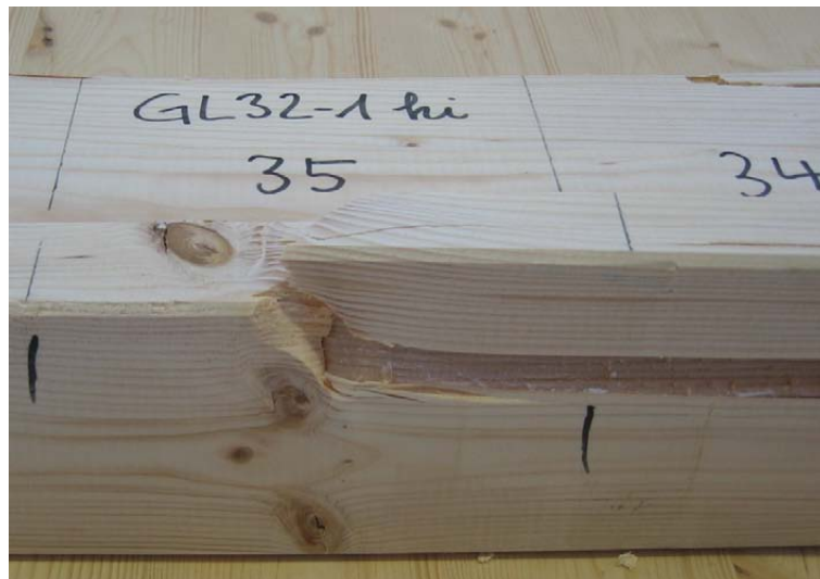
Bild A-76 GL32c-1: Holzversagen in der Randlamelle
