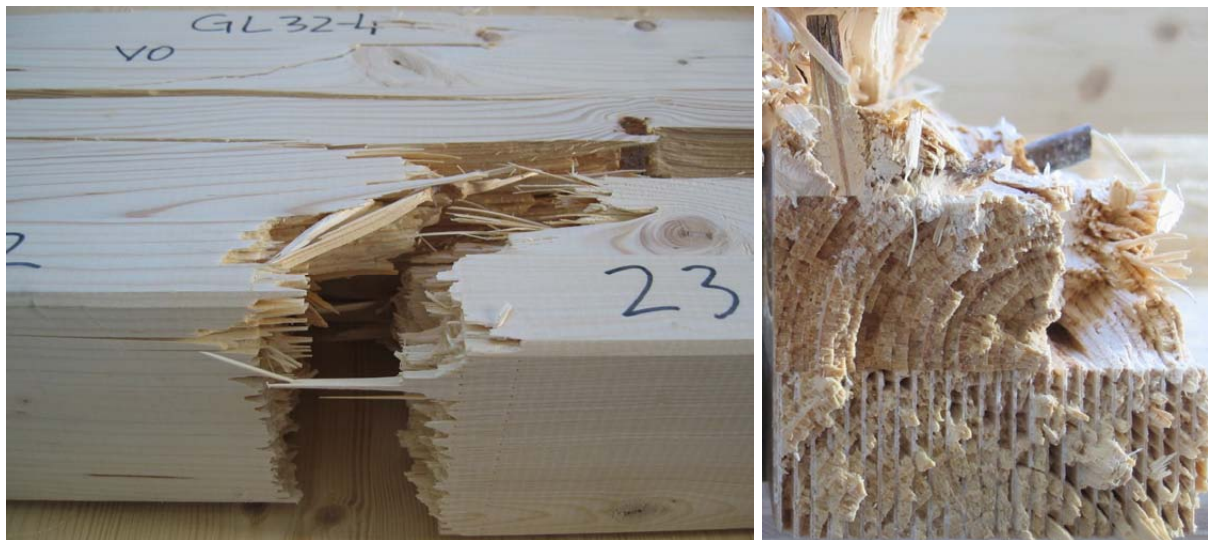
Bild A-79 GL32c-4: Keilzinkenversagen in der Randlamelle, Untersicht (links) und Detail (rechts)
