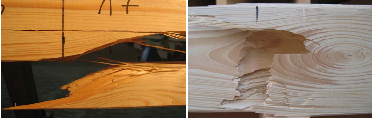
Bild A-8 Träger 6: Holzversagen in der Randlamelle; Seitenansicht (links) und Ansicht von unten (rechts) der Bruchstelle
