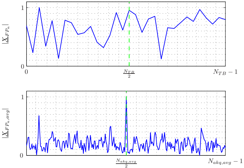
Bild 5.7 Vergleich der Spektren des Signalvektors \underline{\mathbf{X}}_{FP_n} (oben) und \underline{\mathbf{X}}_{FP_n,avg} (unten) bei einer Übertragung nach DRM-Kanalmodell 1 und einem Signal-zu-Rausch-Verhältnis von 30 dB
