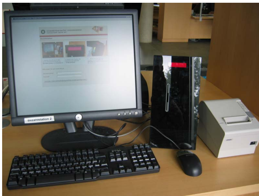
Bild 2: Bezahlstation mit Abwerter der Fa. Maas (schwarz) und Quittungsdrucker
