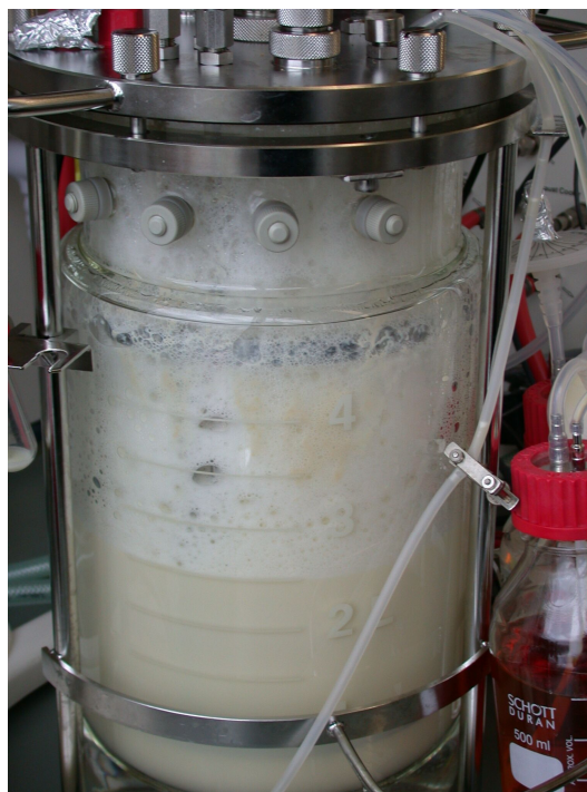
Abb. 5.1 Schaumbildung während einer konventionell begasten Fermentation in einem 5 L Glasreaktor mit Pseudomonas species DSM 2874 auf Sonnenblumenöl nach ca. 72 h.
