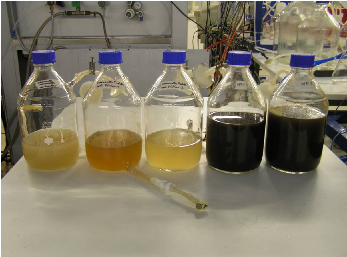
Abbildung 6.25: Bild der Schottflaschen mit den verschiedenen Flüssigkeiten nach der ISMS (von links: Wasch-, 2x Elutions, 2x Redispergierungsflaschen)
