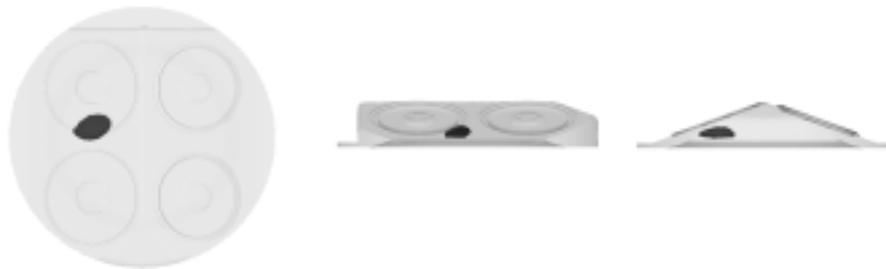
**Abbildung 10:** Mittels CFD-Simulation berechneter Zündherd,  $n_{Mot}=2000 \text{ min}^{-1}$ ,  $p_{mi}=2,3 \text{ bar}$
