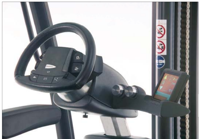
6: Bedienkonzept „Concept 05“ in dem die Bedienung aller primären Funktionen in das Lenkrad integriert ist
