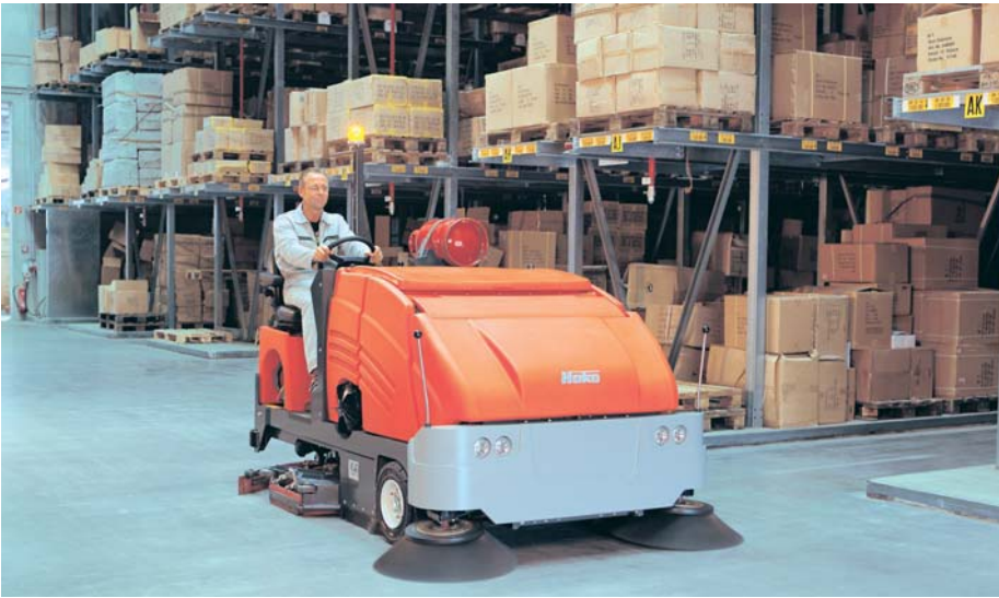
9: Aufsitz-Scheuersaugmaschine Hakomatic 188 LPG für hohe Flächenleistung und lange Laufzeit
