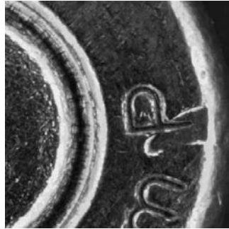
Bild 5.2: Überlagerung des Bodenstempels und der Auswerferspur auf der rechten Seite im Buchstaben „P“.
