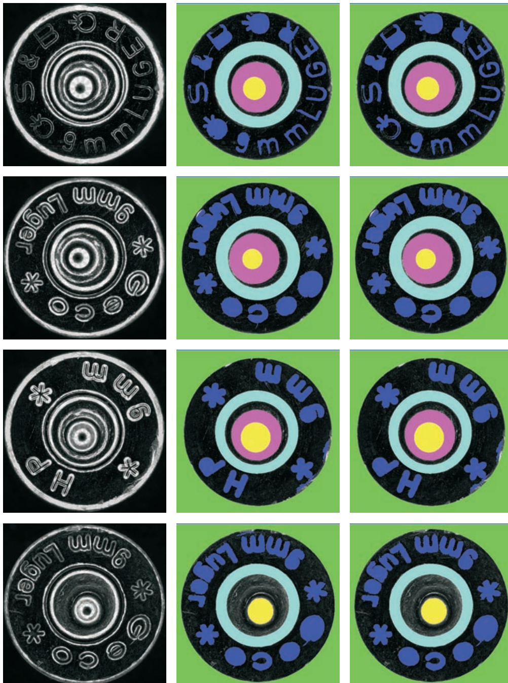
Bild A.2: Gesamtergebnis der Segmentierung des Hülsenbodens. Spalte 1: Ausgangsbild; Spalte 2: Ergebnis der CCL-Variante; Spalte 3: Ergebnis der Graph-based Image Segmentation -Variante.
