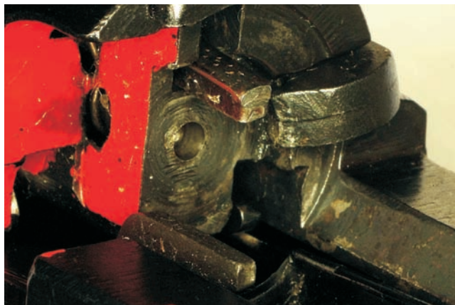
Bild 1.2: Detailansicht des Stoßbodens. Zu erkennen sind die Spuren der Herstellung der Waffe auf dem Stoßboden.
