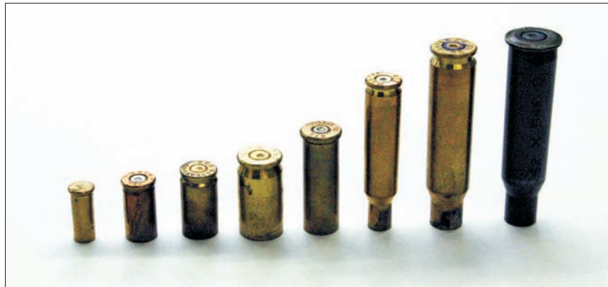
Bild B.4: Verschiedene Hülsenarten. Zu erkennen sind die unterschiedlichen Höhen und Durchmesser der Patronenhülsen sowie die bei den Patronen für Langwaffen üblichen Einschnürungen am Patronenmund.
