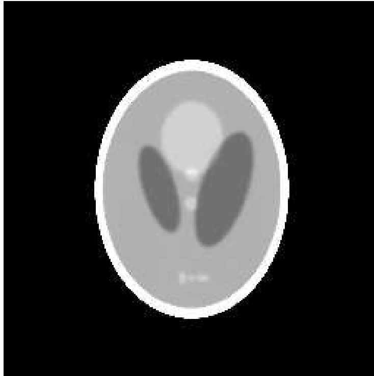
Abb. 10.3: Rekonstruiertes Shepp-Logan Phantom.
