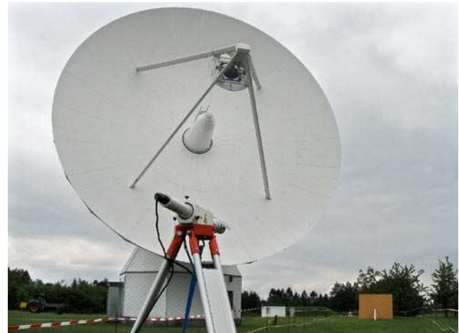
Abb. 6: Szintillometer und sein Laserbereich im Messgebiet seitlich des RTW
