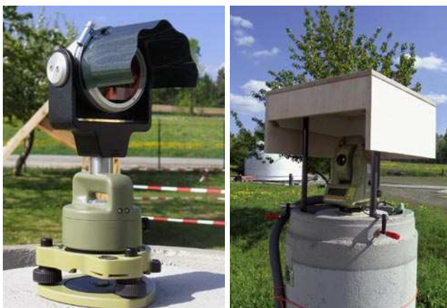
◀ Abb. 4: GPH1P (links) und TCA2003 (rechts) mit Schutzdach
