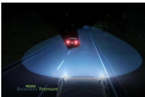
**Abbildung 2 – „Maskiertes-/ Blendfreies Fernlicht“ [12]**
