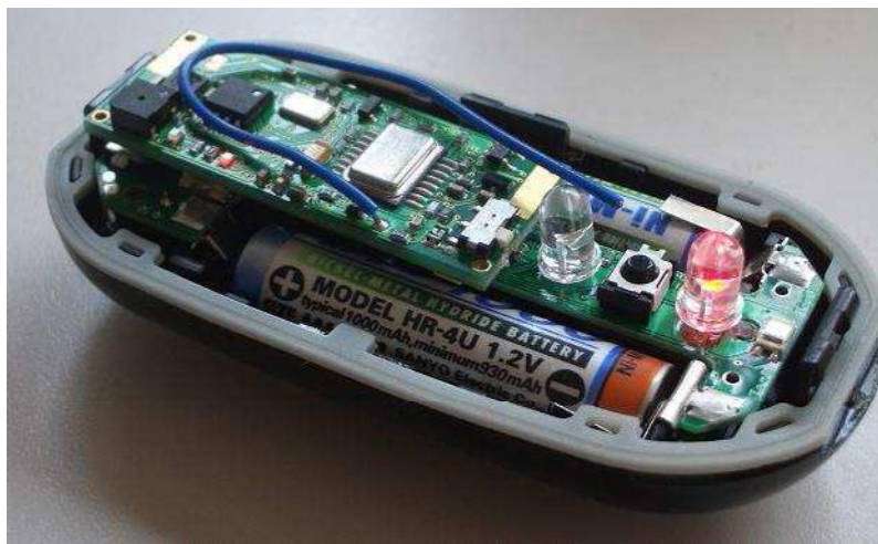
Abbildung 7.17: CoBIs Bauvariante der Particle Computer Plattform für die experimentellen Untersuchungen der PControl Regelung. (Quelle: [166])
