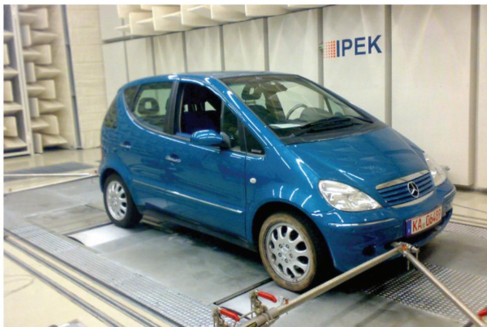
Bild 6.2: Anfahruntersuchung am Vehicle-in-the-loop Prüfstand (ARP)
