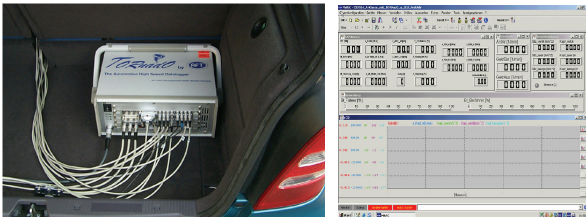
Bild 6.3: Datenlogger und Benutzeroberfläche der Auswertungssoftware
