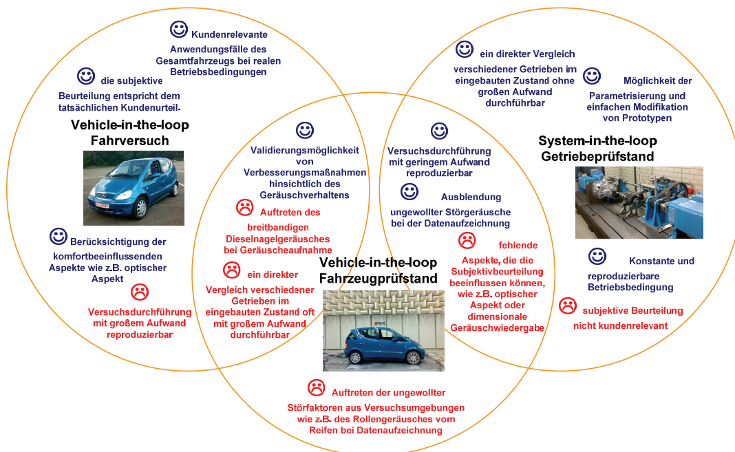
Bild 8.2: Vor- und Nachteile der Prüfumgebungen zur Getrieberasseluntersuchung
