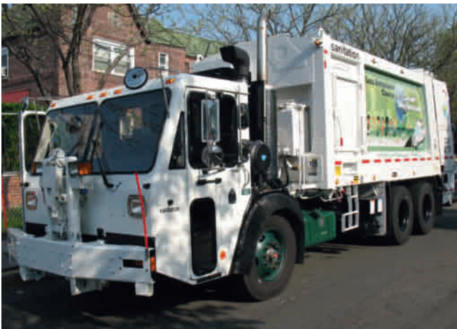
Dieses Abfallsammelfahrzeug fährt mit einem hydraulischen Hybridantrieb durch New York. Bild: Bosch Rexroth
