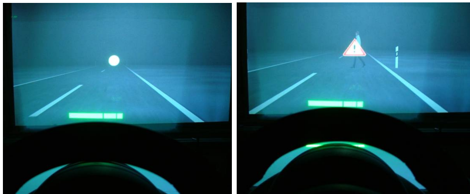
Abbildung 2.2: Warnvarianten zur Anforderungsanalyse, links: Lichtimpuls, rechts: Symboldarstellung
