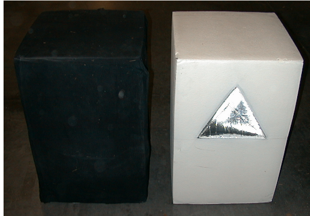
Abbildung 8.1: Quader mit Retroreflektor als stehendes Hindernis, links mit schwarzem Stoff umhüllt
