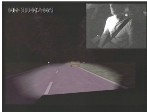
Abbildung 3.2: Screenshot der simulierten Abblendlichtverteilung
