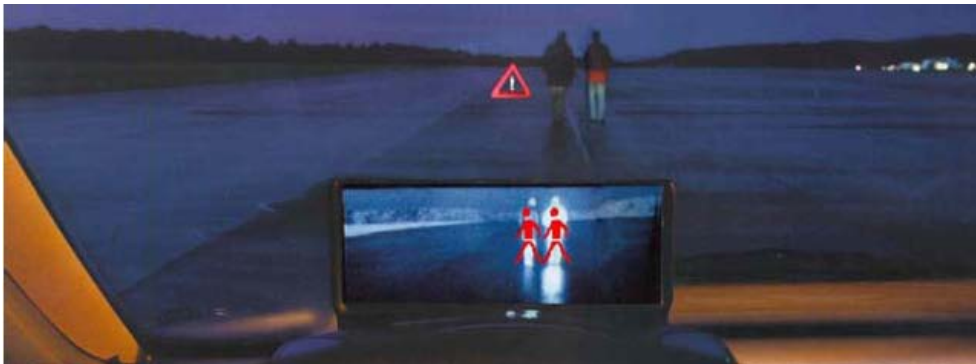
Abbildung 1.6: Die beiden Warnstufen des EUCLIDE-HMI bei der Annäherung an Fußgänger
