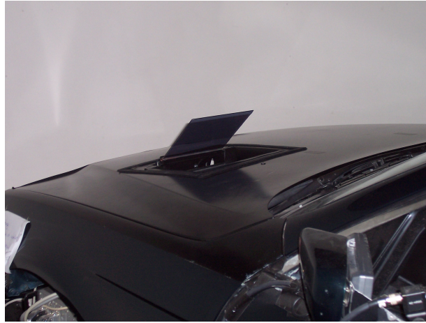
Abbildung 3.3: Außenansicht des Mockups mit integriertem HUD
