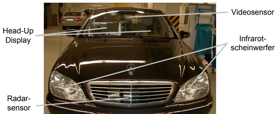
Abbildung 3.15: Integration der Sensor- und HMI-Komponenten in den Versuchsträger
