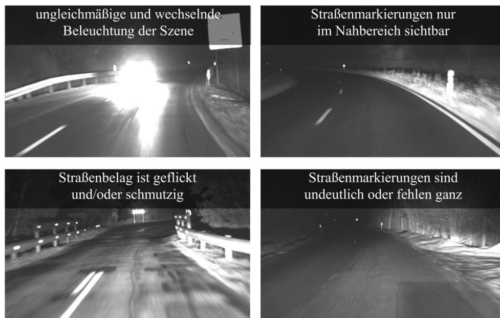
Abbildung 3.12: Fehlerquellen bei der Spurdetektion [5]
