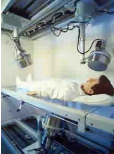
Abb. 5.1 : Messung im Ganzkörperzähler
