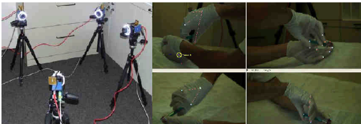
Abb. 2.9: Links: Vier Kameras mit denen das Bestrahlungsszenario aufgezeichnet wird. Rechts: Markerbestückte Hände aufgenommen aus den vier Kameraperspektiven.
