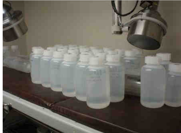
Abb. 5.4: Schilddrüsenphantom im Flaschenphantom
