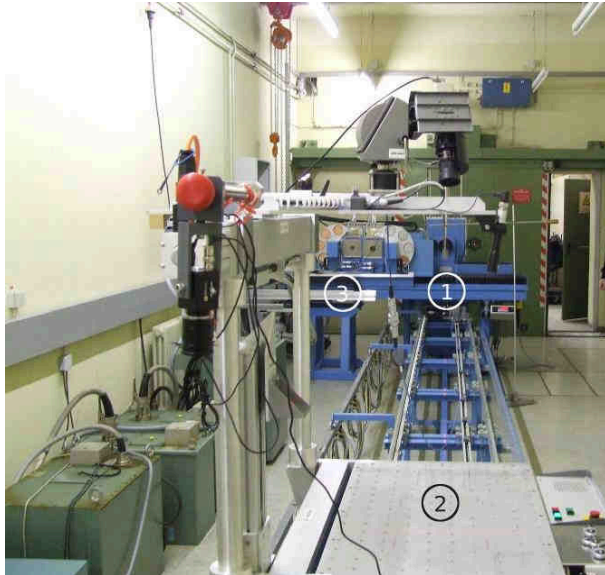
Abb. 2.1: Ansicht des Betonbunkers [Har09]: Im Vordergrund ist der Messwagen (2) zu sehen, blau im Hintergrund die Cs-137 Bestrahlungsanlage (1) und die Röntgenanlage (3)
