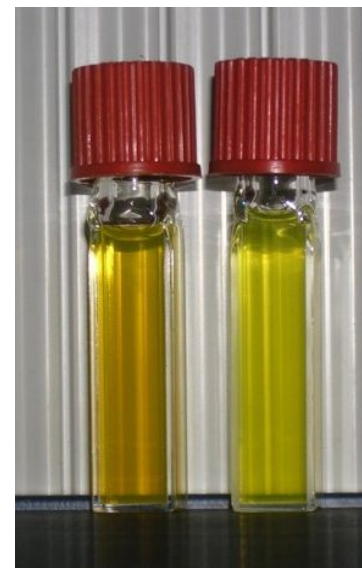
Abbildung 58: Suspensionen von ZrO(FMN) (links) und ZrO(HPO 4 ) 0,9 (FMN) 0,1 in EtOH (1 Gew.-%).
