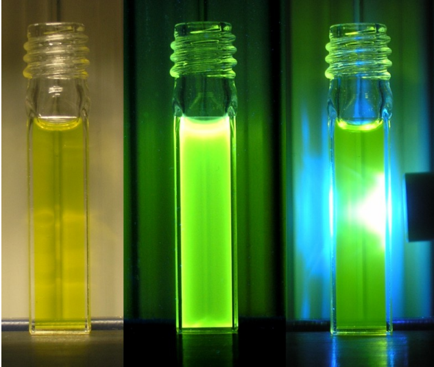
Abbildung 63: Suspensionen der \text{ZrO}(\text{FMN}) -Nanopartikel in EtOH (1 Gew.-%). Links: Tageslicht, Mitte: UV-Licht 366 nm, rechts: blaue LED.
