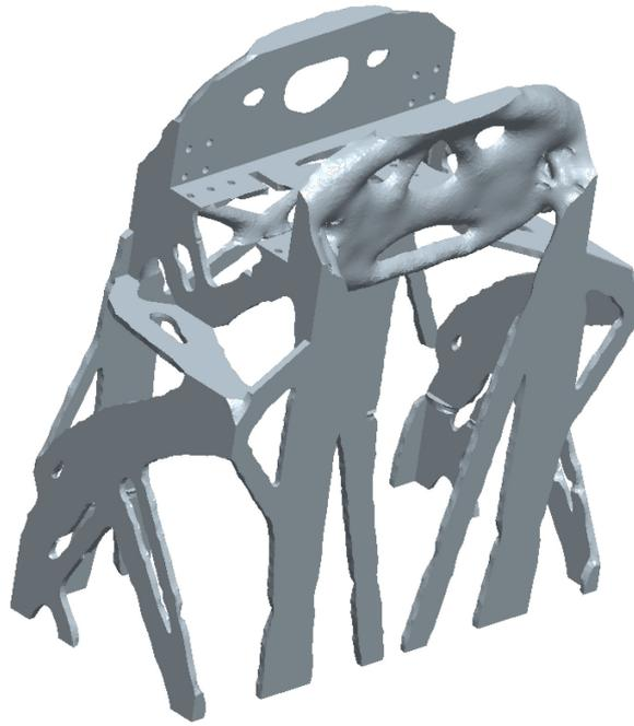
Abbildung 6-19. Ergebnis der Topologieoptimierung des Thorax<sup>190</sup>
