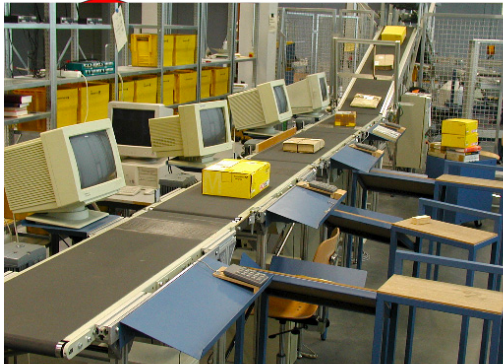
Abb. 13: Prototyp-Versuchsstand einer geteilten Bandzuführung
