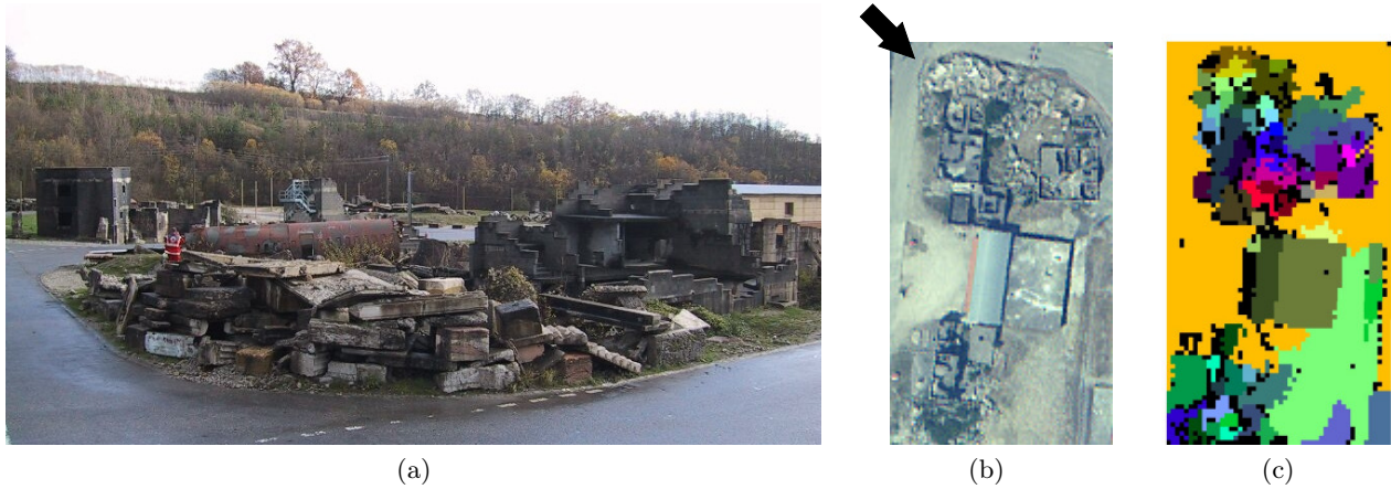
Abbildung 24: (a) Gebiet mit eingestürzten Gebäudestrukturen (Foto: M. Markus); (b) Orthophoto des Gebiets aus (a), wobei die Richtung des eingezeichneten Pfeils der Aufnahme-Richtung in (a) entspricht; (c) Ergebnis der Flächensegmentierung des Gebiets aus (b) (schwarz: unsegmentierte Pixel).
