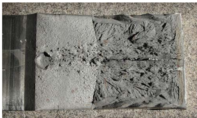
Bild 5: Bruchfläche einer CTOD-Probe
