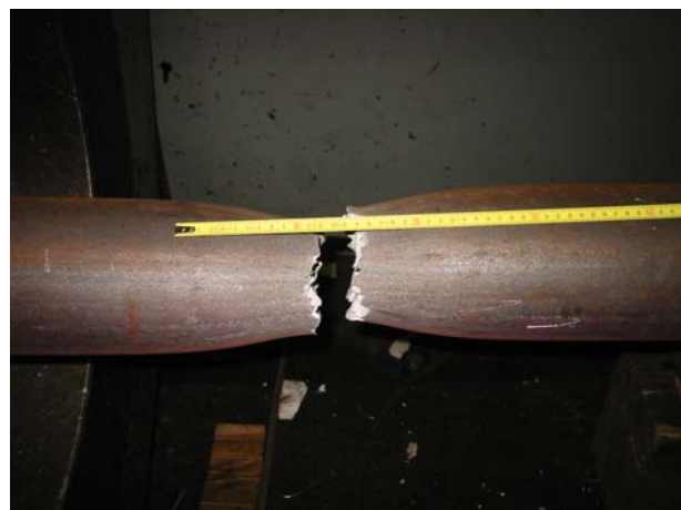
Bild 12 b: Außerhalb des gekühlten Bereiches gebrochener Probekörper nach vorhergehender Plastizierung
