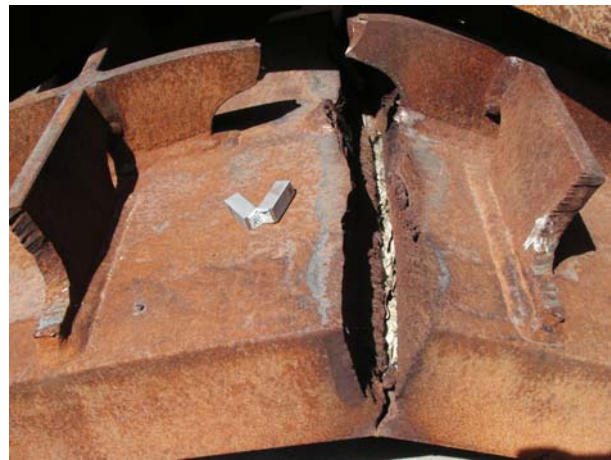
Bild 10: Bruchbild nach Biegeversuch
