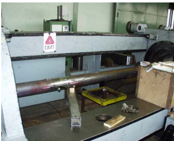
Bild 12 a: Probekörper in einer Zugprüfmaschine
