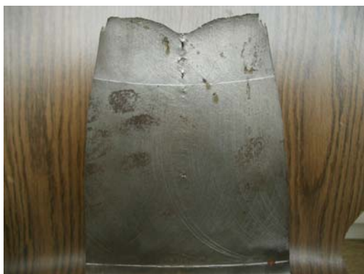
Bild 4: Zugprobe in Walzrichtung
