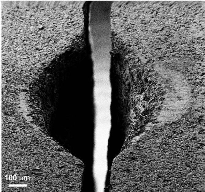
Abbildung 5-27: Al<sub>2</sub>O<sub>3</sub>-Probe 176, gebrochen nach 5.967.758 Zyklen,  $\sigma_{R,max} = 210$  Mpa,  $F_N = 20$  N,  $\varnothing = 5$  mm
