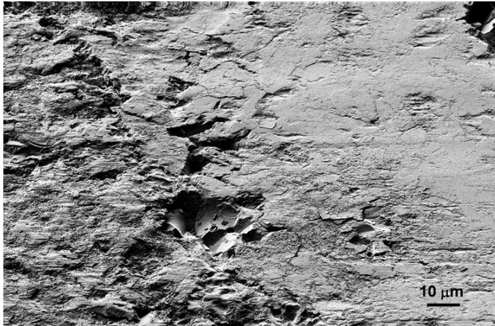
*Abbildung 5-44: Oberfläche mit Ausbrüchen von  $\text{Al}_2\text{O}_3$  in Selbstpaarung nach  $10^6$  Zyklen bei  $p_{\text{max}} = 2311\ \text{MPa}$*
