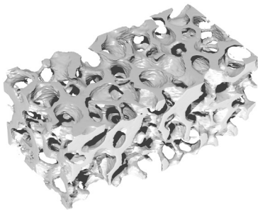
Abb. 3.1: 3D-Rekonstruktion eines für die MRI-Experimente verwendeten Quaderstücks eines 10 ppi- \text{Al}_2\text{O}_3 -Schwammes ( \psi = 80 \% )
