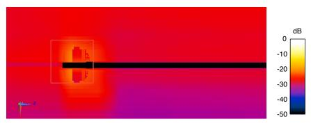
(d) SAR distribution (averaged over 10 g), maximum in slice: 2.69 mW/g.
