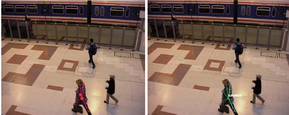
Abbildung 3.7: Bild links: Überschneidungen von Detektionen auf Merkmalsebene. Die zwei roten Kreise zeigen zwei von einer Person generierten Maxima die als Objekthypothesen übernommen werden, die aber von teilweise gleichen Bildmerkmalen verursacht wurden. Bild rechts: die stärkste Detektion wurde ausgewählt. Nach neuer Zuverlässigkeitsbewertung der zweiten Detektion nach Entfernen der überschneidenden Merkmale, ist die Stärke dieser Detektion zu gering, um eine Objekthypothese aufrecht zu erhalten.
