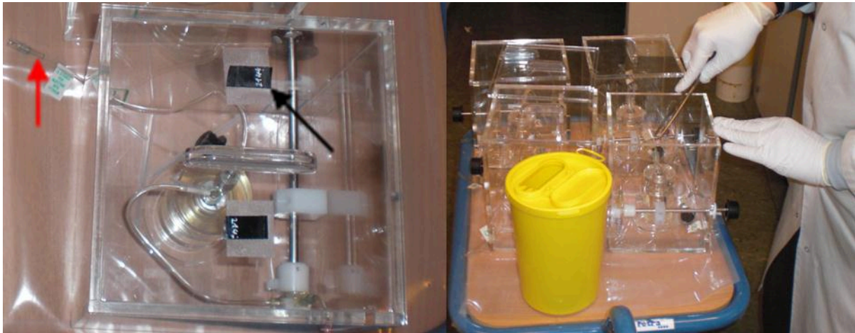
Abb. 2.8: Die Entsorgung des Schlauchsystems führt zu hohen Handdosen. An der Innenseite des Deckels (siehe schwarzer Pfeil) wurde eine Dosisleistung von bis zu 130 mSv/h gemessen. Der rote Pfeil zeigt auf einen unabgeschirmten Applikationsschlauch, der mit einem Katheter verbunden ist.
