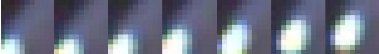
Abb. 2.3: Intensitätsgewichtete Approximation an den Marker. Die helle Fläche des Markers verschiebt sich in Richtung der Mitte des betrachteten Bildausschnittes
