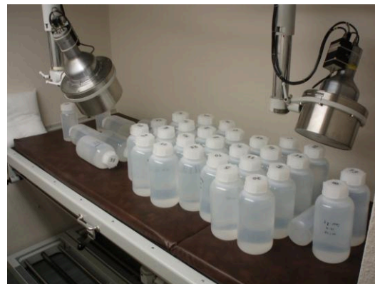
Abb. 4.9: Phantom „breite Oberschenkel“
