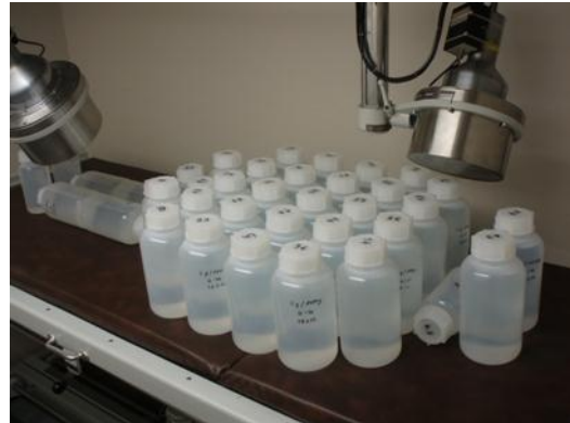
Abb. 4.7: Phantom „breiter Oberkörper“
