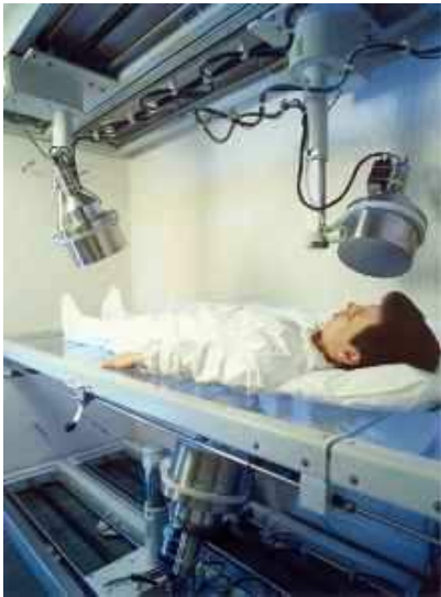
Abb. 5.1: Messung im Ganzkörperzähler
